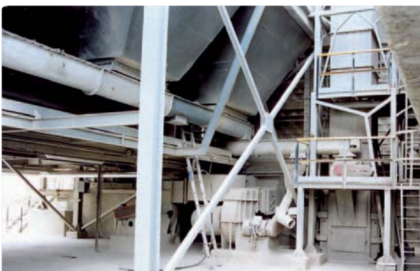
Sinfín colector en fondo de filtro de homo.
